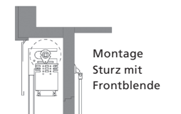
Montage in Sturz mit Holzblende
