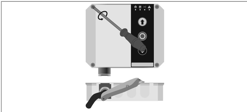
Öffnen Sie den Deckel der Steuerung. Ziehen Sie das Kabel vom Deckel ab und legen den Deckel vorsichtig beiseite. Entfernen Sie die benötigten Ausbrüche im Unterteil des Gehäuses.
