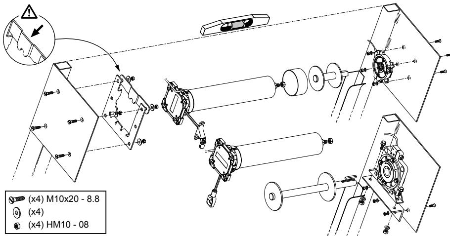
FR- Couple de serrage : 40 Nm / EN- Tightening torque: 40 Nm / DE- Drehmoment: 40 Nm / NL- Aandraaimoment: 40 Nm
