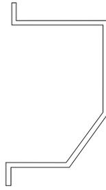
**3 mm Blendenverstärkung für Einbruchschutzklasse 3**
