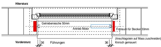
Variante Einschalen-Mauerwerk mit Wärmedämmstein.
