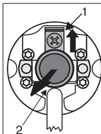
Der Steckzapfen (2) rastet beim Einschoben automatisch ein. Zum Lösen des Steckzapfens (2) das Sicherungsblech (1) nach oben schieben und den Steckzapfen (2) herausziehen.
