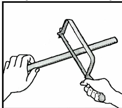
➍ Schneiden Sie die obere Führungsschiene auf Breite der Laibung. Berücksichtigen Sie 8mm für die Kappen.
