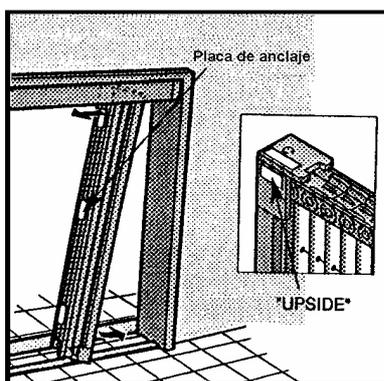
➒ Pressen Sie das feste Element gegen den Türrahmen. (Die Rückseiten der Verankerungsclips tragen Klebestreifen.)
