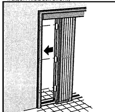
➓ Befestigen Sie die Verankerungsclips mit Schrauben. Benutzen Sie einen Schraubenzieher. Benutzen Sie KEINEN Elektroschrauber!
