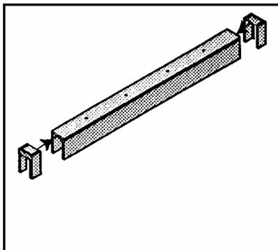
➏ Setzen Sie die Schrauben an den vorgesehenen Stellen ein. Befestigen Sie die obere Führungsschiene.
