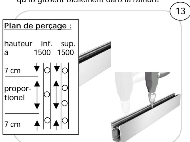
Percer les trous des coulisseaux et de montage dans le mur séparément -> pour bien laisser propre les pièces terminales.
