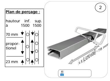
Caisson et 1 joue latérale montée, incl. lame finale, du vide de taille = déduction 9 mm
