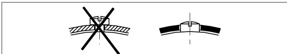
• Ne jamais bloquer le tube d'axe sur le disque d'entraînement : ce sont les têtes de vis qui assurent l'entraînement.
