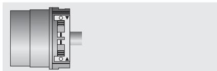
Poussez les deux interrupteurs de la position de programmation en position d'effacement.
