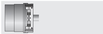
Poussez l'interrupteur de la position finale correspondante de la position de programmation en position d'effacement.
