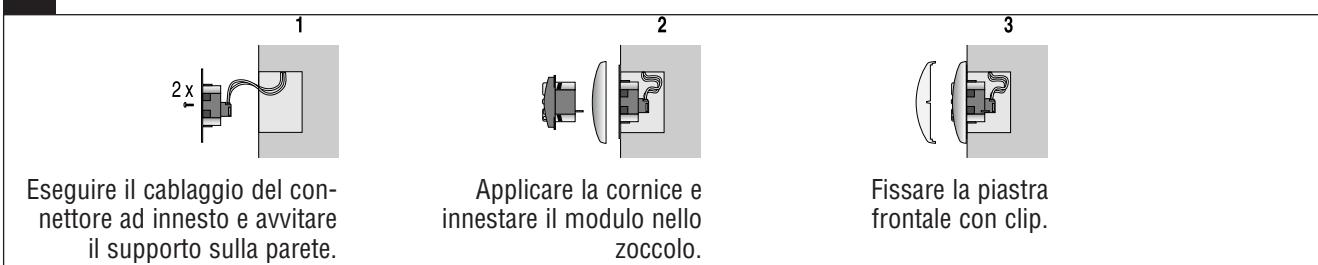
Eseguire il cablaggio del connettore ad innesto e avvitare il supporto sulla parete.
