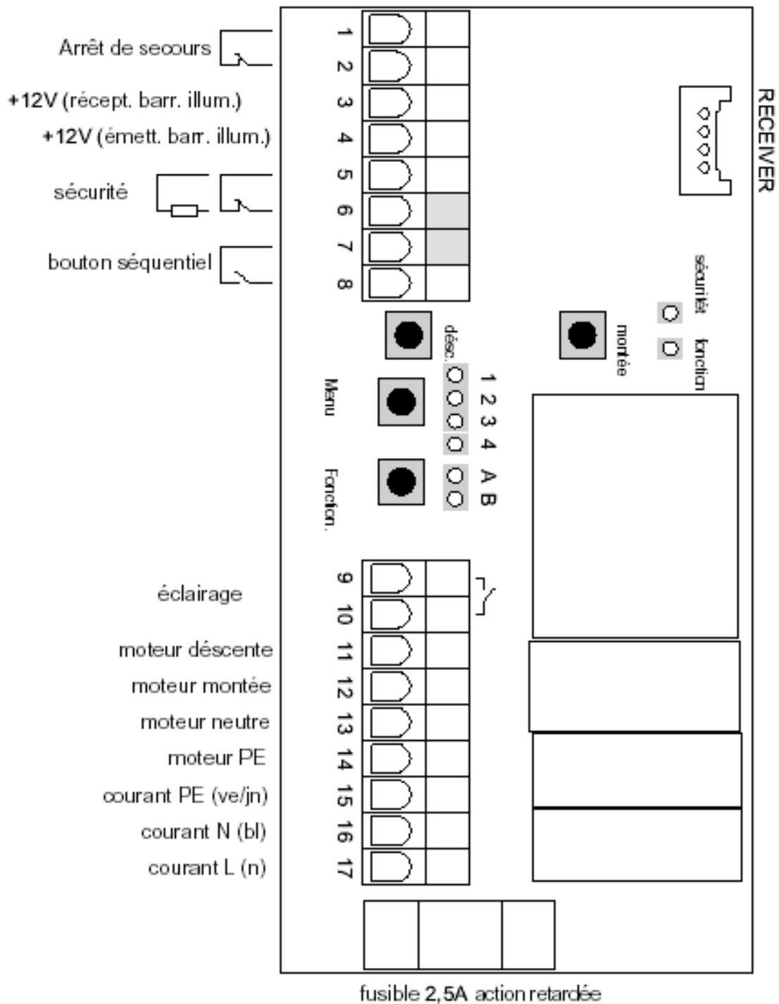
Le raccord "éclairage" est un contact de relais sans potentiel, c'est à dire qu'on n'y dispose d'aucune tension. La tension nécessaire pour la lampe peut uniquement être couplée.
