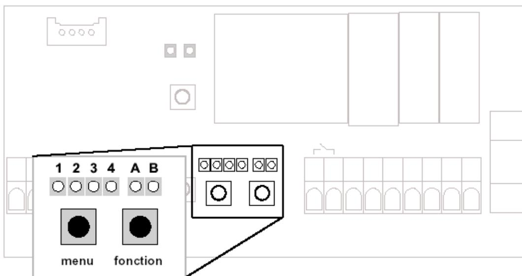
La touche « MENU » sélectionne le paramètre à régler (1..4). Avec la touche « FONCTION », selon l'option respective, une valeur est sélectionnée ou une fonction déclenchée (A, B).
