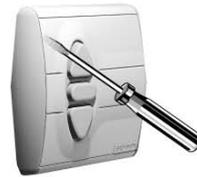
Lösen der Abdeckplatte mit einem Schraubenzieher.
