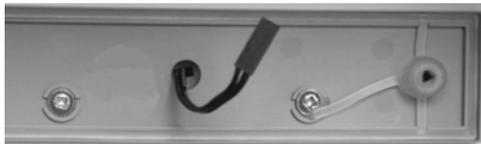
Schließen Sie den Steckverbinder der Kontaktleiste an die 2 Kontaktstifte an, die sich an der elektronischen Schaltung des Kontaktleisten-Senders befinden.
