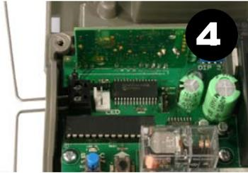
Die zwei Antennen aus der Verpackung nehmen und sie an den Empfänger schrauben (Positionierung der Antennen und des Steckverbinders oben links an der Elektronikkarte, siehe nebenstehend). Stellen Sie sicher, dass sich die beiden Antennen nicht berühren, nicht überkreuzen und in die entgegengesetzte Richtung zeigen (eine nach oben, eine nach unten, beide parallel zur Produktseite).
