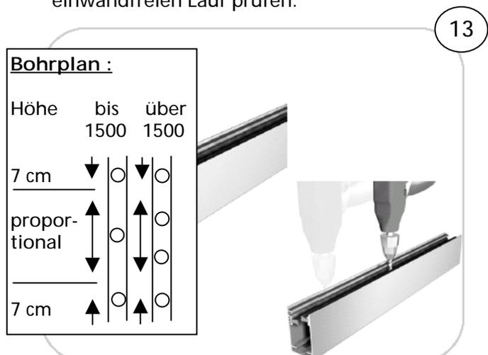
Mauer-Loch unbedingt getrennt von Führungsloch bohren -> damit kein Bohrstaub in Führung
