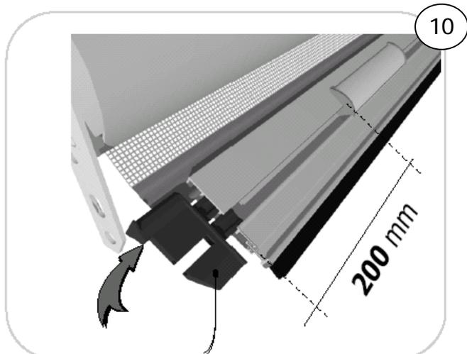
Seitenkappe in Endschiene einfügen
