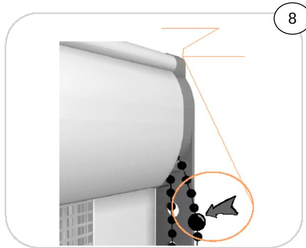
Kettenstopp so positionieren, dass unten die Teleskopendschiene ein- und ausgehängt werden kann, in unterster Position aber durch Kugel gebremst wird.
