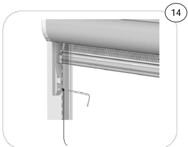
Im untersten Loch der Seitenkappe die Madenschraube anziehen (kein Montageschraubenloch)
