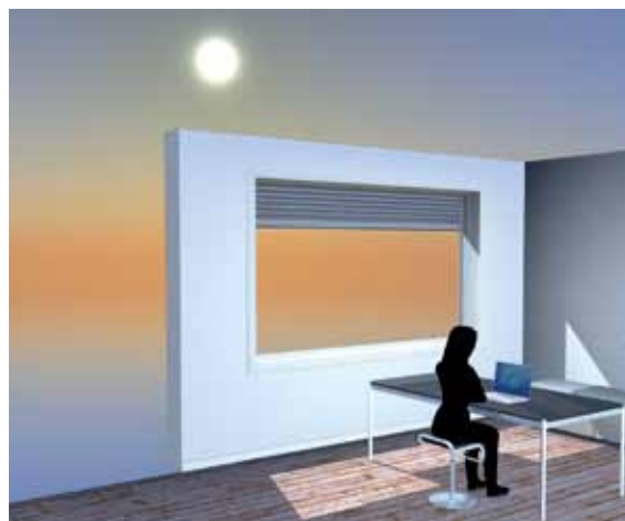
En été: travailler sans être ébloui. Le volet roulant est seulement un peu fermé lorsque le soleil est haut.
