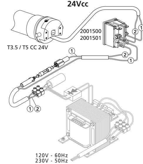
Le transformateur doit être de type **Très Basse Tension Sécurité**
