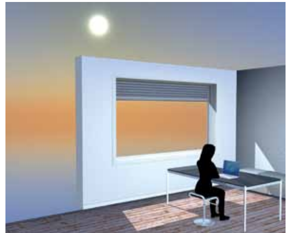
Sommer: Arbeiten, ohne geblendet zu werden. Der Rollladen wird bei hohem Sonnenstand nur ein wenig geschlossen.
