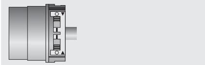
Schieben Sie beide Schalter von der Programmier-Stellung in die Lösch-Stellung.
